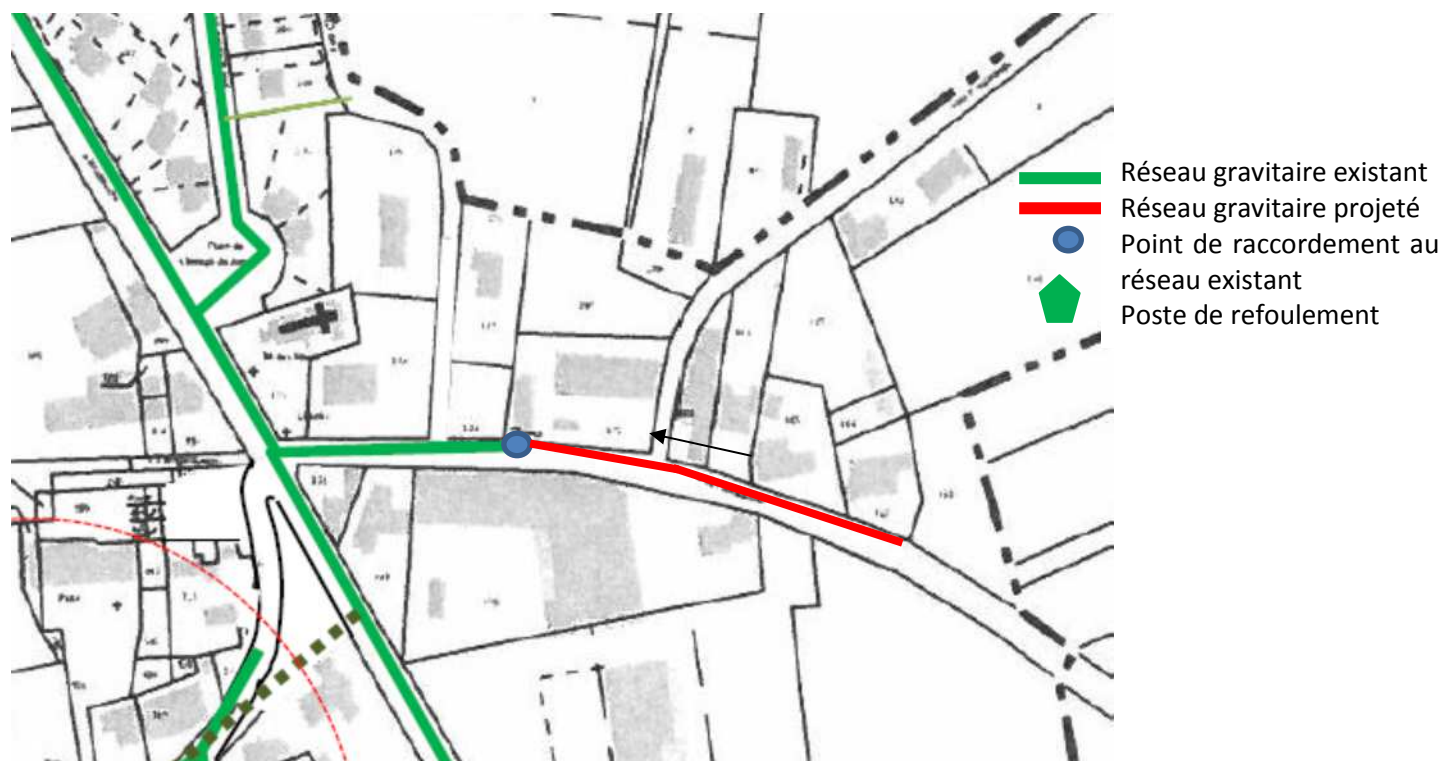
Figure 8 : Tracé possible de l'assainissement collectif
